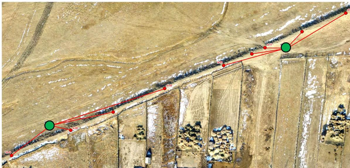
**Рисунок 7.** Ортофотоплан с. Усть-Иля с наземными опорными точками (выделены зеленым) и контрольными точками аэрофотосъемки с БПЛА (выделены красным), отрезками показаны кратчайшие расстояния от контрольных до опорных точек
