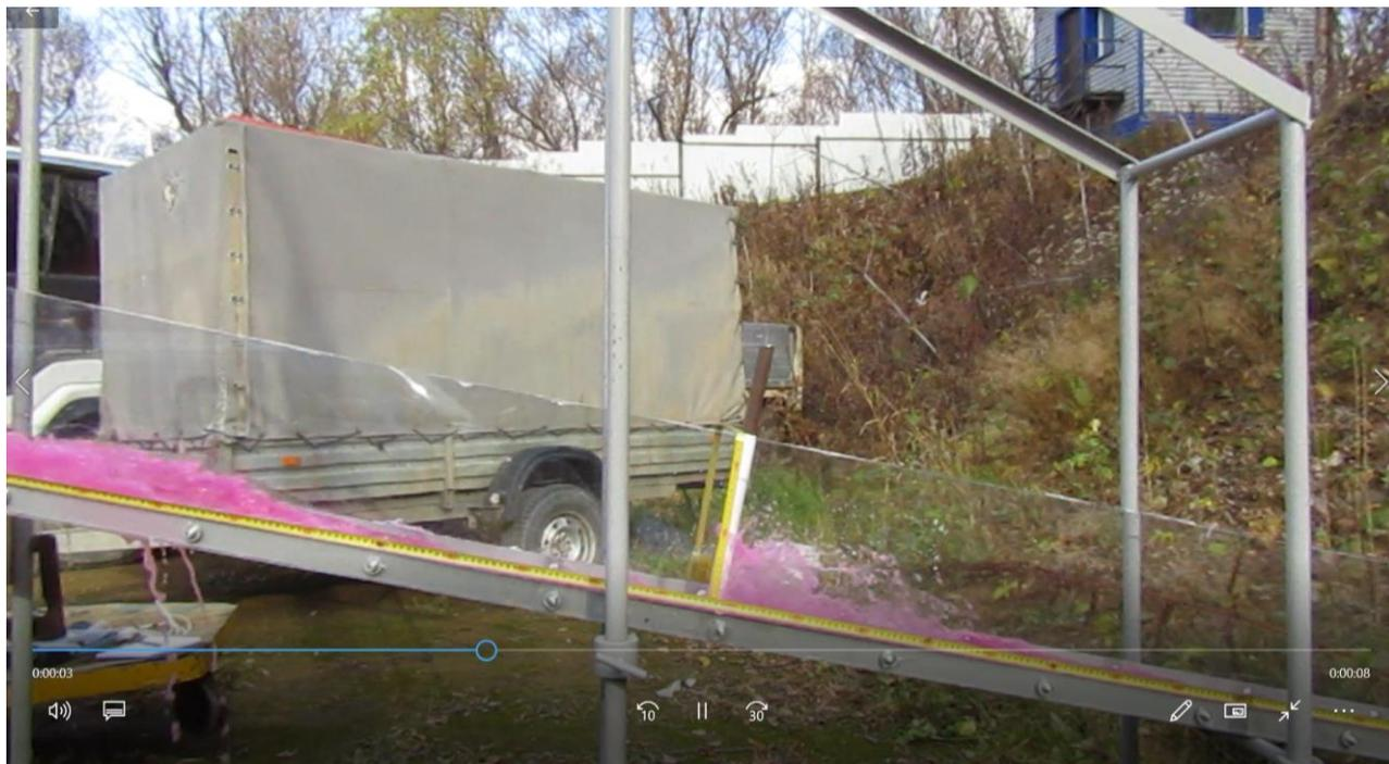
**Рисунок 3.** Движение водного потока по селевому лотку
