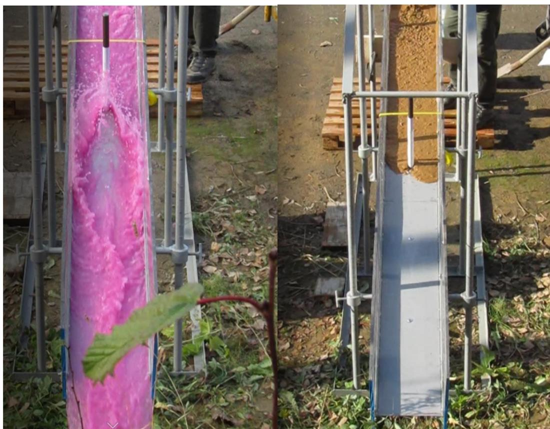
**Рисунок 4.** Движение водного (1) и селевого (2) потока по селевому лотку
