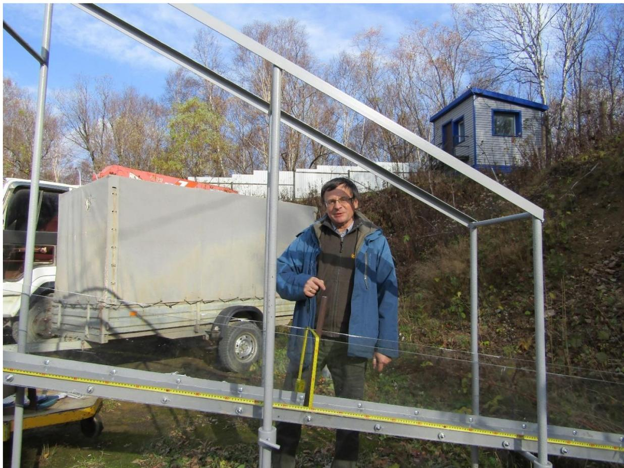
**Рисунок 2.** Стенд для экспериментальных исследований динамики селей
