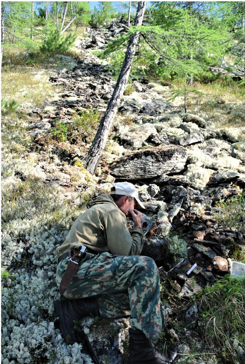
**Рисунок 4.** Измерение скорости течения воды в каменном потоке (дрена Беличья). Бассейн ручья Контактный, Колымское нагорье. Фото О.М. Макарьевой.
