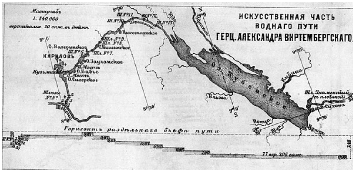
Рисунок 1. Ситуационный план и продольный профиль канала им. Герцога Александра Вюртембергского (Северо-Двинской шлюзованной системы) по состоянию на 1898 г.
