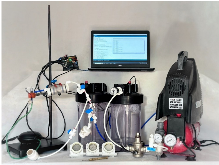
Рисунок 4. Автоматизированный комплекс для фильтрационных и миграционных испытаний в образцах слабопроницаемых материалов (фото М.А. Царева)
