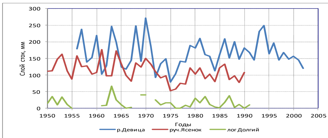
Рисунок 2. Изменения годового стока р. Девица - п. Товарня, руч. Ясенок и лога Долгого (НДВБС).
